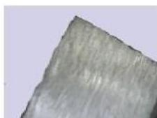
現在使用 SP 溶解洗淨 (70°C的 4 小時) ADC12 時，幾乎不形成金屬皮膜，清洗效果顯著。
