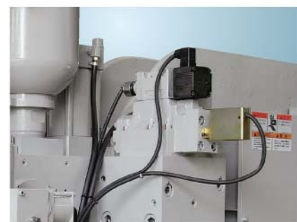
■ 油压伺服阀（选购配置） 在高速压射领域发挥出实力。 提高了减速的稳定性。 可以选择速度控制。
