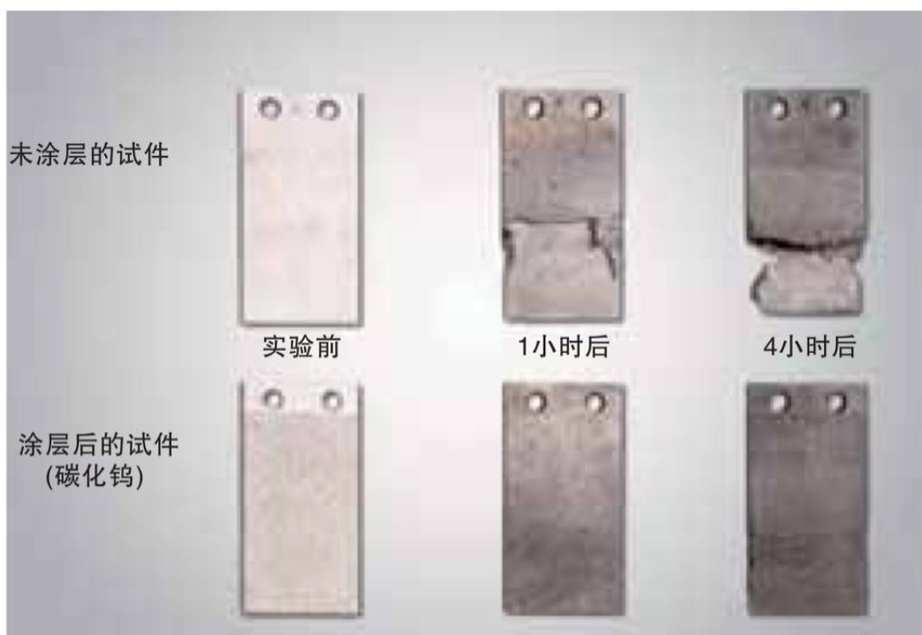
实验条件 试件:SKD-61 熔融金属:ADC-12(680°C) 浸渍到熔融金属中以30RPM旋转
