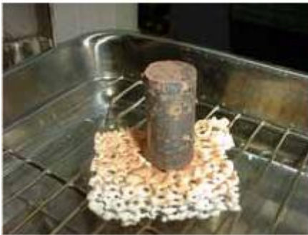
大気冷却後 皮膜剥離
