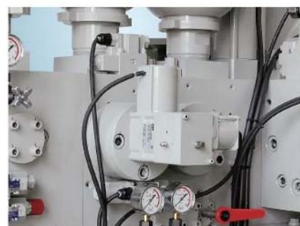
■ 射出电动流量阀 能够远距离调节压射速度。 也可进行速度与升压时间的自动补正。
