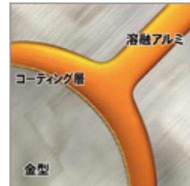
已批复处理：在硬度350–400HMV，批复上2000HMV以上硬度批复层，防止磨损。
