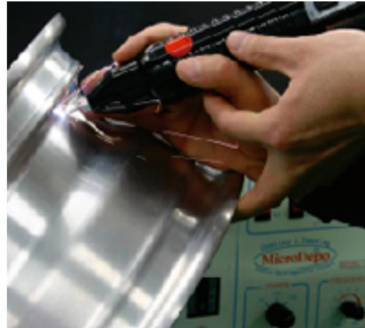
アルミダイカスト・鋳造製品に発生した巣、ピンホール、欠肉などはアルミ合金の電極で肉盛補修し、製品の不良率を低減できます。
